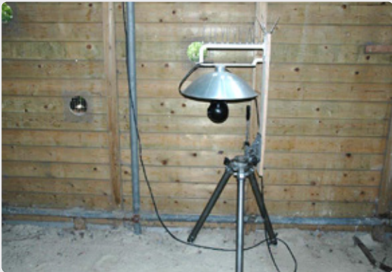
Foto 5. Op afstand beweegbare filmcamera in de vliegkooi; de lampkap beschermt de camera tegen o.a. de uitwerpselen van de uilen.
